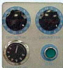
Double minuterie mécanique séchage / refroidissement
